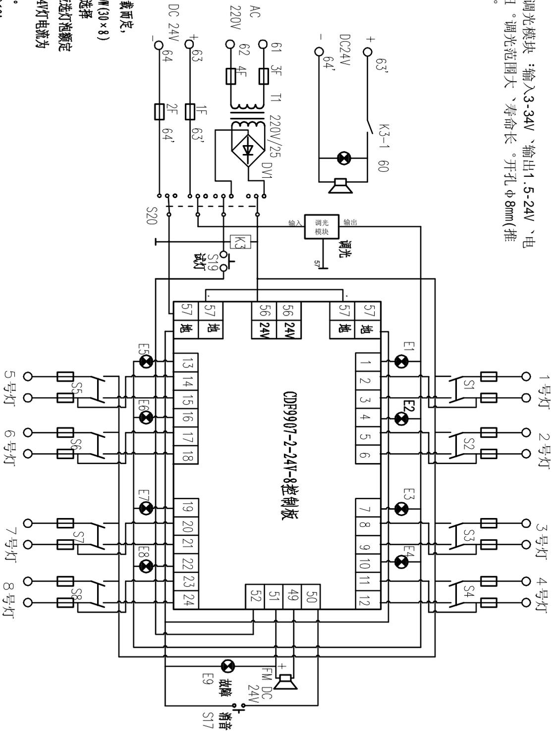
注意：1、变压器T1容量根据灯泡负载而定，
